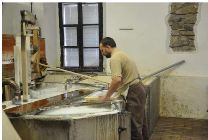
Ruční načerpání papíroviny na síto
